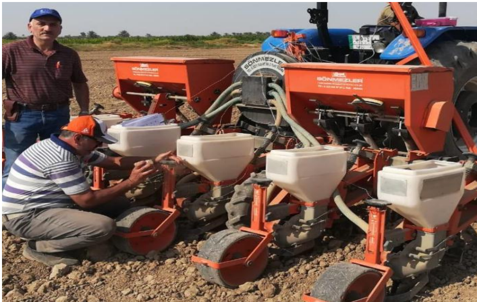
شكل (1) تنظيم عمل البادرة مع طريقة ربطه بالساحبة
